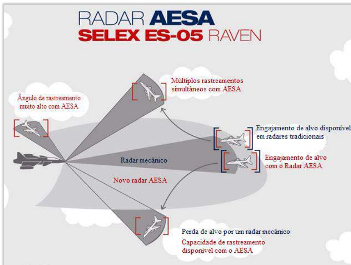
Figura 29 – Comparação do radar Raven AESA ES-05 e outros de plataforma fixa
