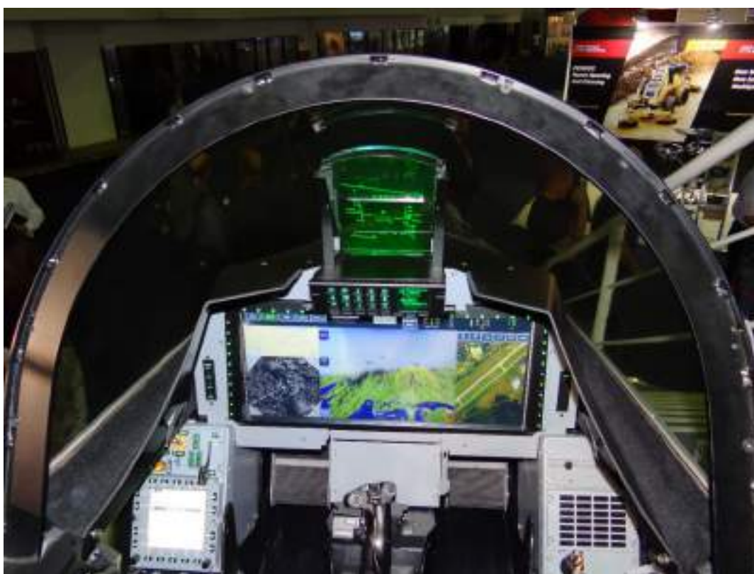
Figura 13 – Tecnologias Wide Area Display – WAD e Head-Up Display – HUD da AEL Sistemas a serem embarcados no Gripen NG
